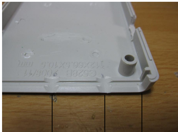
出力ジャックが干渉する部分を丸ヤスリで削る
